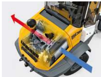
Kühlanlage L 507 / L 509
